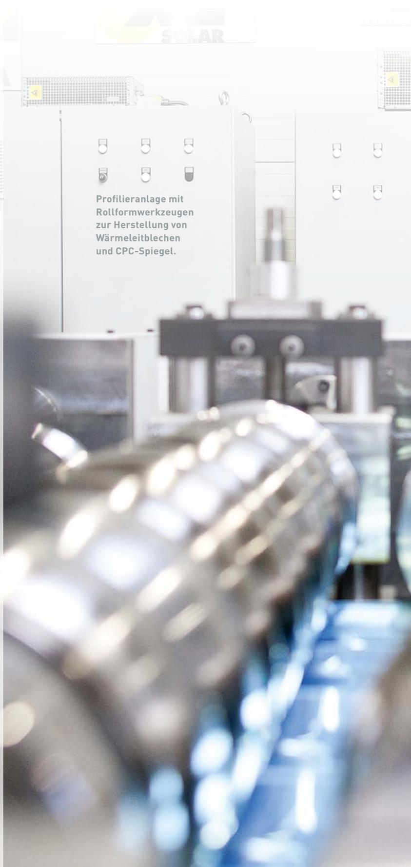
Profilieranlage mit Rollformwerkzeugen zur Herstellung von Wärmeleitblechen und CPC-Spiegel.
