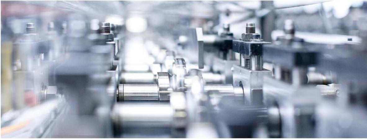
Profilmetall entwickelt zuerst die Rollwerkzeuge, mit denen das Absorberblech in einem sanften und schonenden Prozess umgeformt wird.
