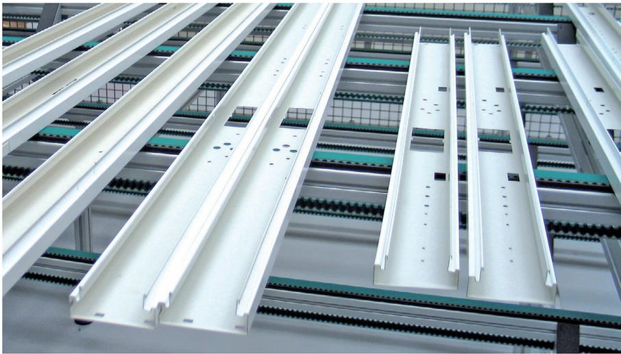
Montagefertige Basisschienen für verschiedene Leuchtentypen und Lampensysteme. (Bilder: Profilmittel)
