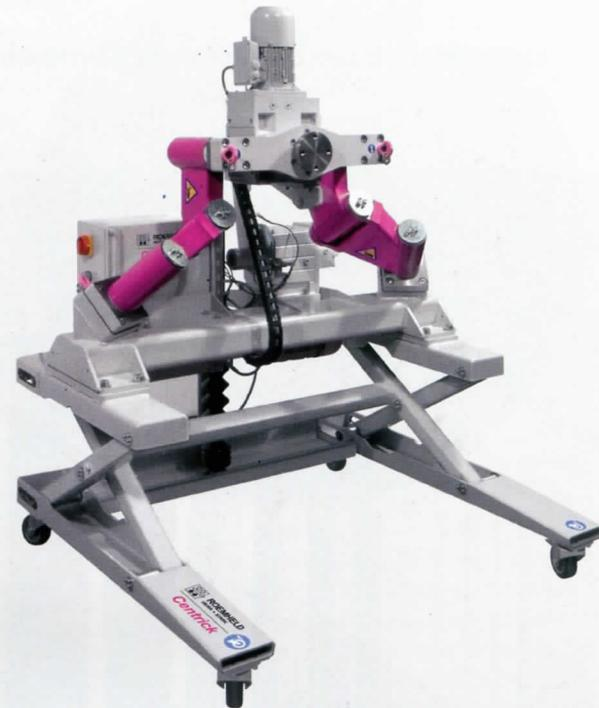
**03** Bei Lasten zwischen 150 und 2000 kg bieten sich die vollelektrischen Dreh-Kipp-Manipulatoren der Centrick-Reihe an
