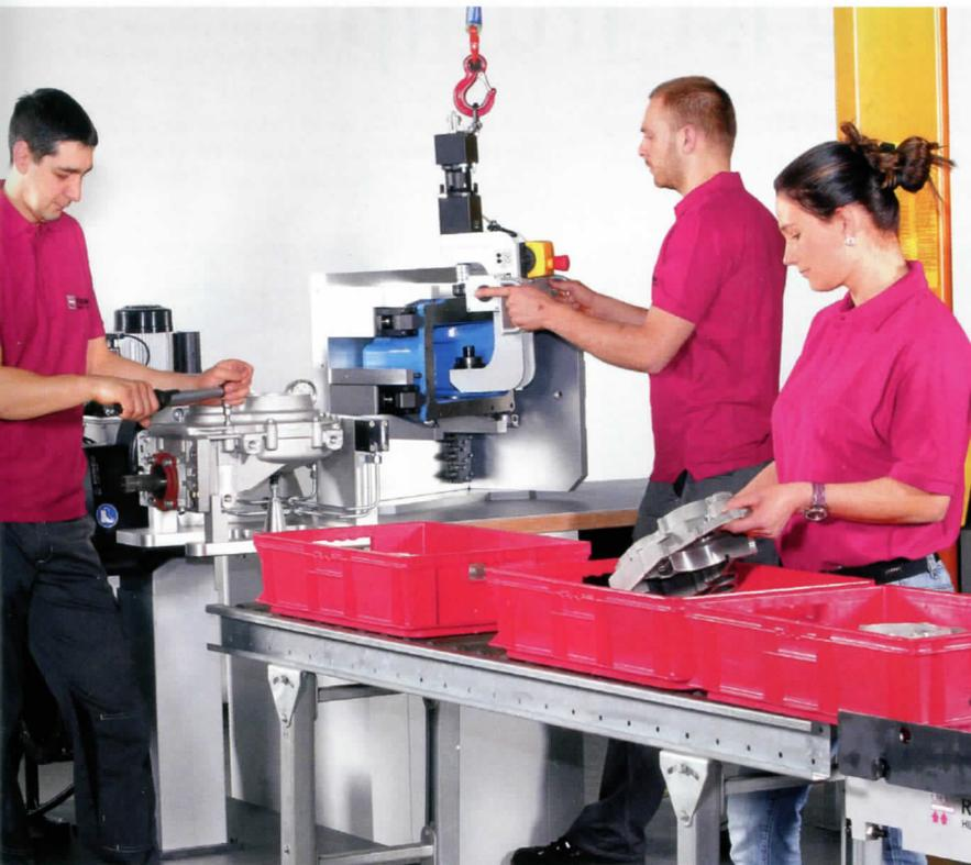
**01+02** Mit dem modulg-Baukastensystem lassen sich ergonomische Arbeitsplätze für das Handling von Bauteilen bis zu 150 kg Gewicht nach den individuellen Anforderungen des Werkers gestalten
