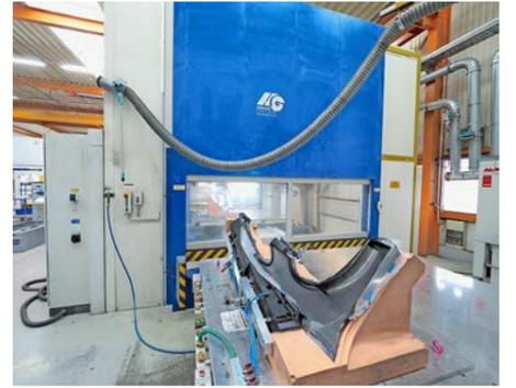
Die Dimensionen der zu bearbeitenden Bauteile betragen bis 2.000 x 2.500 mm, bei Dicken zwischen 1 und 3 mm. Typischerweise bewegen sich die Losgrößen zwischen 500 und 10.000 Stück – manchmal sind es auch nur vierzig Sätze aus linken und rechten Kotflügeln für einen Sportwagen.
