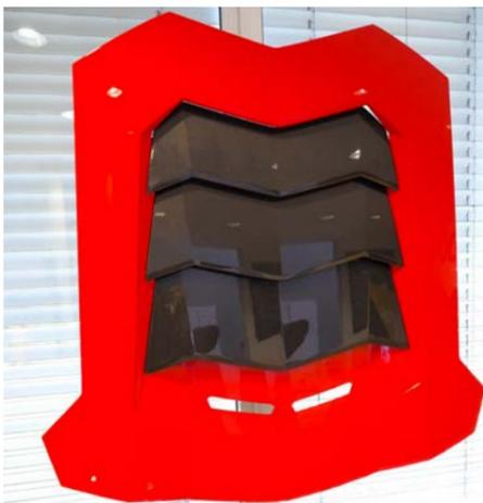
Diese CFK-Motorhaube für einen Lamborghini Aventador wurde bei ACE gefertigt und nachbearbeitet.
