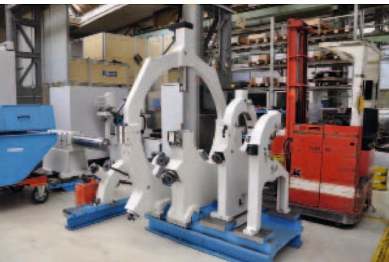
Zusätzlich zur E175 lieferte Weiler vier Lünetten, wovon die größte einen Durchlass von 1.450 mm hat, so dass auch Bauteile mit besonders großen Durchmessern schwingungsfrei und präzise bearbeitet werden können.
