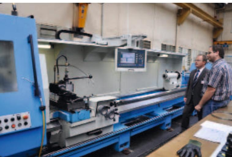
Gefertigt werden auf der zyklengesteuerten Präzisions-Drehmaschine E70 vor allem hochpräzise, dünnwandige Teile mit mehreren Passungen und sehr engen Toleranzen bis 1/100 mm. Dazu gehören sowohl kleinere Pumpenkomponenten mit Durchmessern von 50 bis 700 mm wie auch sehr dünne Bauteile mit bis zu 4 Metern Länge und Durchmesser-Längen-Verhältnissen von 15:1.
