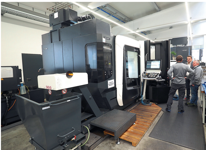
3 Bei FS Technologies sind zwei 'DMU 50'-CNC-Universal-Fräsmaschinen der 3. Generation mit Schwenkrundtisch im Einsatz, die mit einem 24-Platz-Palettenwechsler verbunden sind. Auf ihnen werden mithilfe des Hilma.UC die Komponenten für einen Spanntechnikhersteller gefertigt © Stark Spannsysteme
