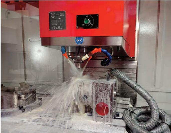
Seit 2024 produziert Walter auf dem Bearbeitungszentrum BA 1500 von Kunzmann mit einem Arbeitsbereich von 1.500x750x900mm (X/Y/Z). Mit dem Teilapparat als vierte Achse lassen sich Bauteile mehrseitig in einer Aufspannung bearbeiten.
